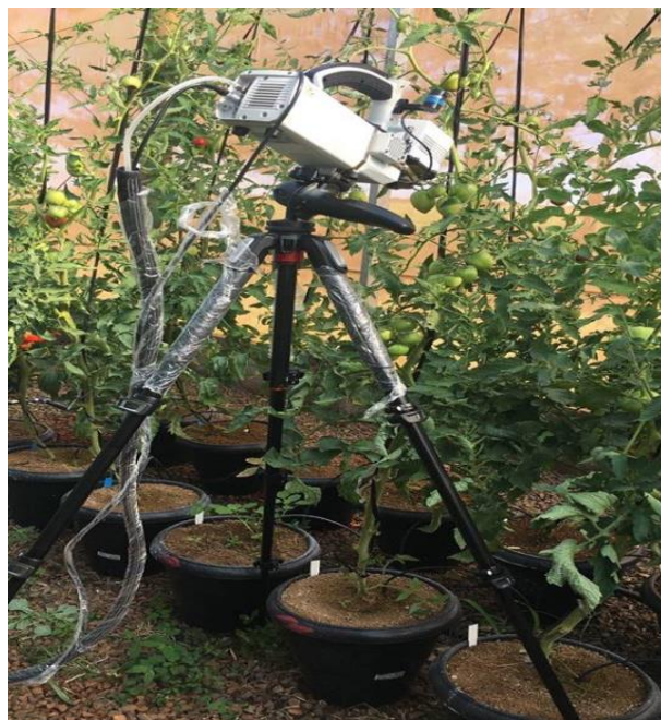
Figura 12. Avaliação de trocas gasosas, utilizando o IRGA ( Infra-Red Gas Analysis ), aos 71 dias após transplântio.
